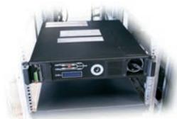
Realice la operación de bypass manual en la unidad defectuosa seleccionando S1 o S2.
